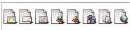
Le icone degli Internet Location File, da sinistra: WEB, e-mail, news, FTP, AppleShare, zona Apple-Talk, file, URL generica.
